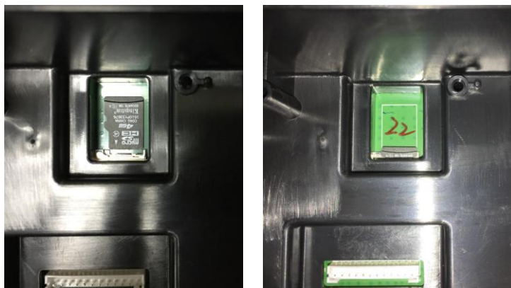
Abbildung 2-5 Einschieben einer SD-Karte in die SD-Buchse (links); SD-Karte installiert (rechts)
