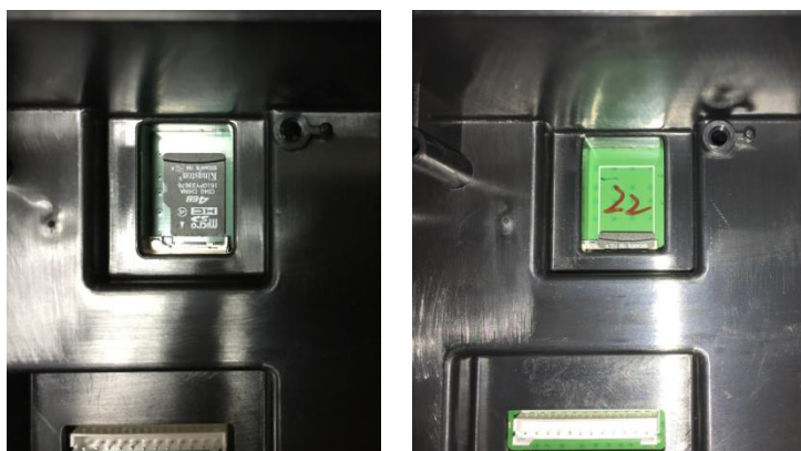
Figura 2-5 Instalando una tarjeta SD en una entrada para SD (izquierda); tarjeta SD instalada (derecha)
