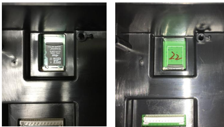
图2-5 将SD内存卡插入插槽中（左）；SD内存卡（右）
